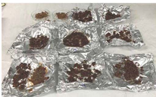
Egindako esperimendu bakoitzaren ostean geratzen den patxa-hondarra eta 105 o tan lehortu ondoren
