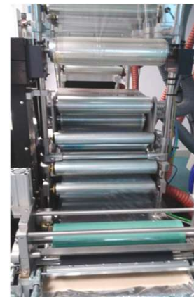
Aplicación de coating barrera sobre PET en Gaiker
