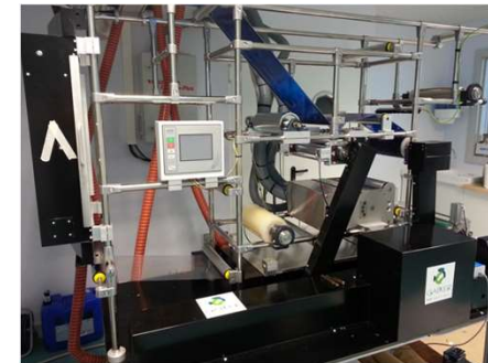
Equipo de aplicación de recubrimientos/impresión/laminación Rotary Coater (Roko).
